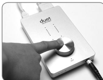
Cliquez au centre du bouton rotatif en façade jusqu'à ce que le témoin **IN-1** s'allume, puis faites tourner le bouton pour obtenir un niveau d'enregistrement adéquat sur la piste activée pour l'enregistrement.
