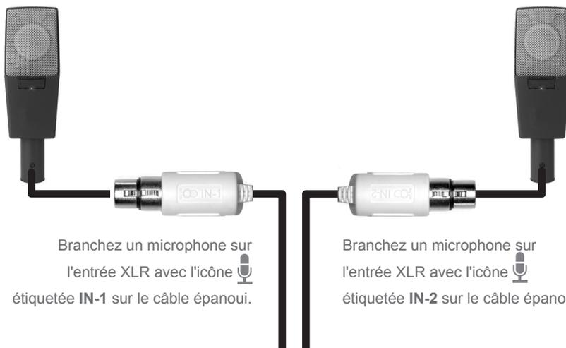
Branchez un microphone sur l'entrée XLR avec l'icône
