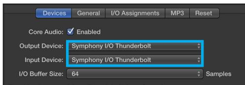
3. Comience por configurar el tamaño del Buffer a “64 muestras”. Ajuste la configuración basada en el desempeño de su computadora
